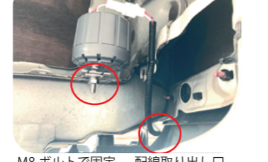
M8 ボルトで固定 配線取り出し口
