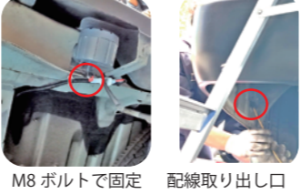
M8 ボルトで固定 配線取り出し口
